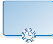
Timer de borde que no interrumpe
